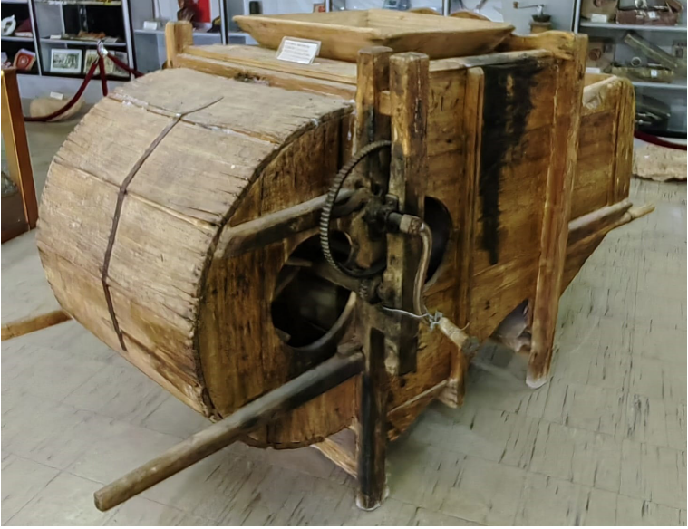
Köylerde bir zamanlar buğday hasadında kullanılan Harman Makinesi (Özel Ali Gürer Müzesi-Ocak Köyü)
